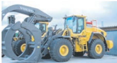
Две единицы спецтехники дополнили автопарк предприятия. В автотранспортный цех прибыли новый фронтальный погрузчик с бревнозахватом Volvo L180H и мобильный перегружатель Fuchs. Функция перегружателя заключается в укладке штабелей круглого леса. Он будет работать либо на территории лесозавода, либо на терминале отгрузки и загрузки круглых лесоматериалов и щепы.
